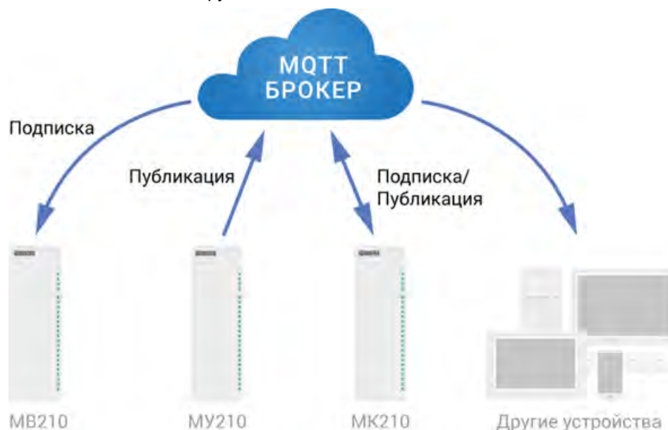
Рисунок 6.5 – Структурная схема обмена по протоколу MQTT
