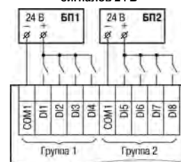
Рисунок 8 – Подключение к дискретным входам датчиков типа «сухой контакт» для сигналов 24 В
