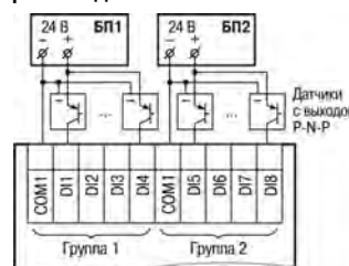
Рисунок 7 – Схема подключения к дискретным входам трехпроводных дискретных датчиков, имеющих выходной транзистор р-п-р-типа с открытым коллектором для сигналов 24 В
