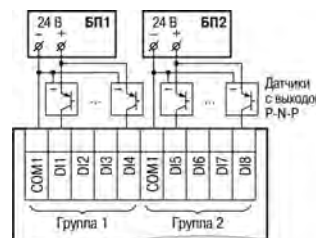
Рисунок 7 – Схема подключения к дискретным входам трехпроводных дискретных датчиков, имеющих выходной транзистор p-n-p-типа с открытым коллектором для сигналов 24 В
