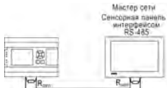
Рисунок 12 – Типовая схема подключения в режиме Slave
