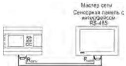
Рисунок 13 – Типовая схема подключения в режиме Slave
