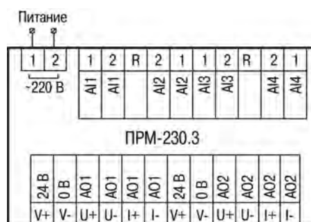
Рисунок 5.3 – Назначение контактов клеммника прибора с питанием 230 В
