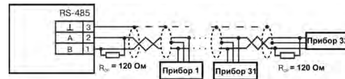
Рисунок 1 – Схема подключения ПВ210.WEB по интерфейсу RS-485
